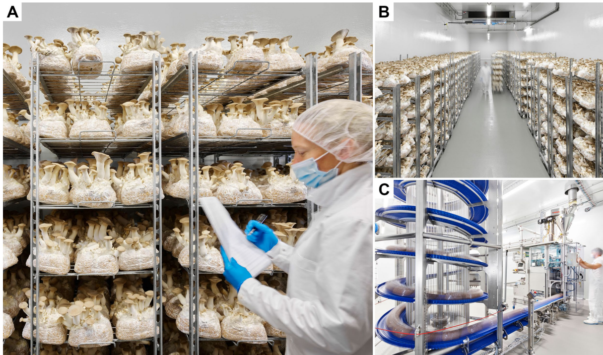
Abbildung 2. (A) Kontrolle des Wachstums von Kräuterseitlingen unter hygienischen Bedingungen in einer Produktionsanlage. (B) Wachstumskammer mit automatisch regulierter Temperatur, Feuchtigkeit und CO 2 -Konzentration. (C) Automatisiertes Befüllen von Kultursäcken mit Substrat. Fotos bereitgestellt von der Neuburger Fleischlos GmbH .
