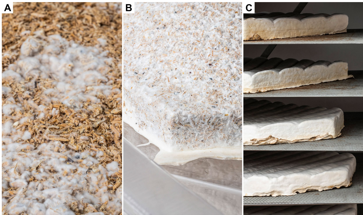
Abbildung 3. (A) Wachstum von Pilzmyzel auf lignocellulosehaltigem Substrat (B) Vollständig durchwachsener Substratblock in vorgefertigter Form (C) Myzelmaterialien bei der Trocknung. Fotos bereitgestellt von SQIM S.r.l.
